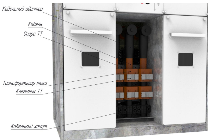
Рис. 7.2 Кабельный отсек с ТТ
