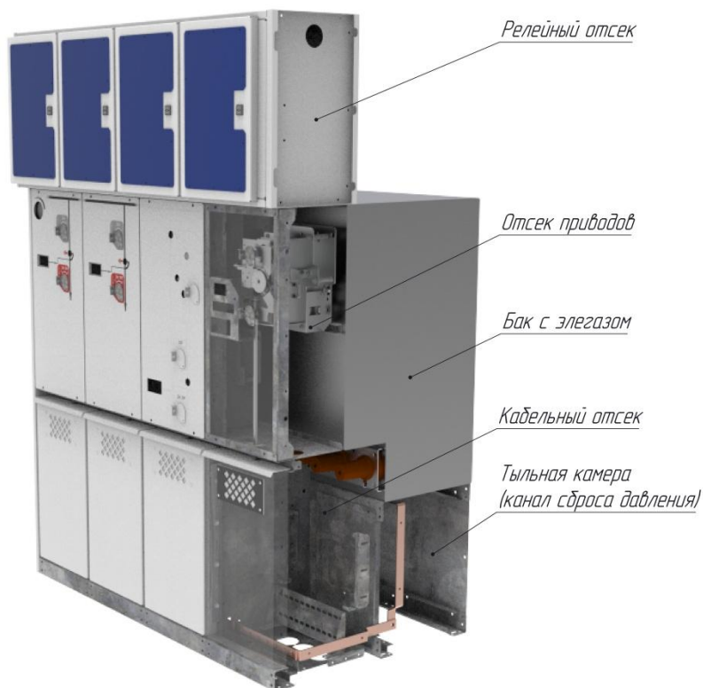
Рис. 1.1 Разделение на отсеки
